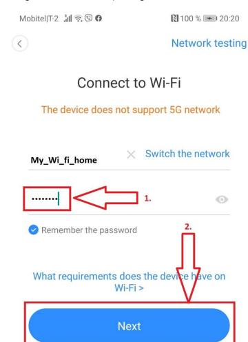
Geben Sie das Passwort Ihres WLANS ein (Feld 1) und klicken Sie "Next". In der Zwischenzeit wurde die Kamera bereits zurückgesetzt (es dauert 1-2 Minuten), Sie sollten ebenso einen Klang von der Kamera hören, welcher Sie informiert, dass die Kamera bereit ist für das Scannen des QR-Codes, der auf dem Mobilgerät im folgenden Schritt gezeigt wird.
