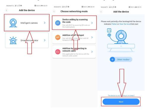
Im Pop-up-Fenster "Add the device" klicken Sie zunächst "Intelligent camera", sofort danach im folgenden Fenster "Choose networking" klicken Sie "Device adding by scanning the code". Geöffnet wird das dritte Pop-up-Fenster, in welchem Sie "Next" klicken – diesen Vorgang stellen die obigen 3 Bilder dar.
